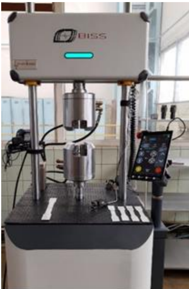
Рис. 6.25. Універсальний сервогидравлічний випробувальний комплекс nanoBISS.
