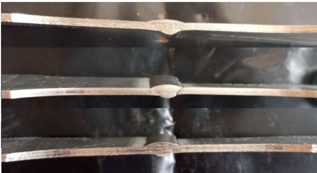
Рис. 6.18. Зовнішній вигляд профілів досліджуваних зразків після випробувань на осьовий статичний розтяг.
