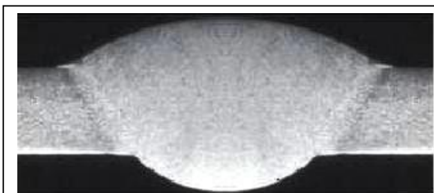
Рис. 4.5. Макрошліф стикового з'єднання алюмінієвого сплаву АМг6М товщиною 1,8 мм, отриманого АДЗНЕ [205].
