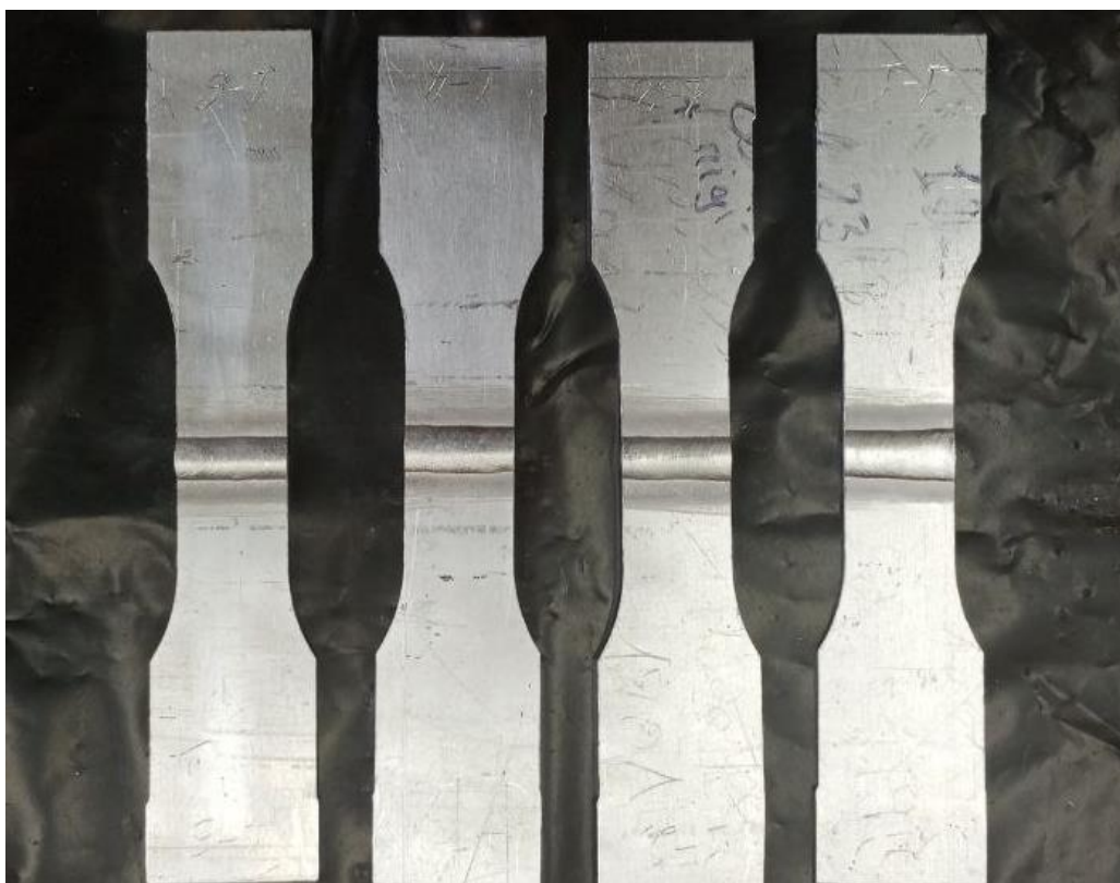
Рис. 6.10. Зовнішній вигляд зразків для статичних та циклічних випробувань.
