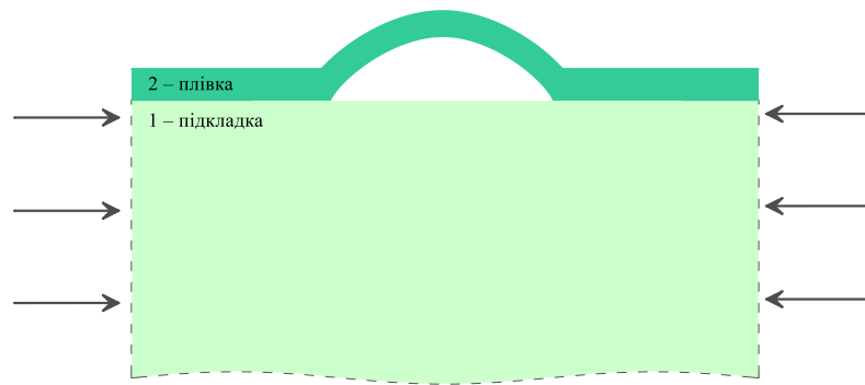
Рис. 4.1 – Випучування тонкої плівки на напівобмеженій підкладці.
