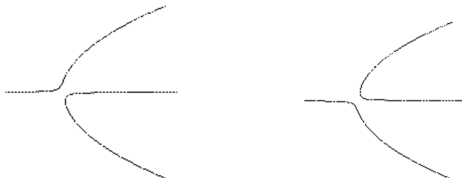
Рис.1.4. В случае общего положения и лишь одного управляющего параметра бифуркация вилки структурно неустойчива.
