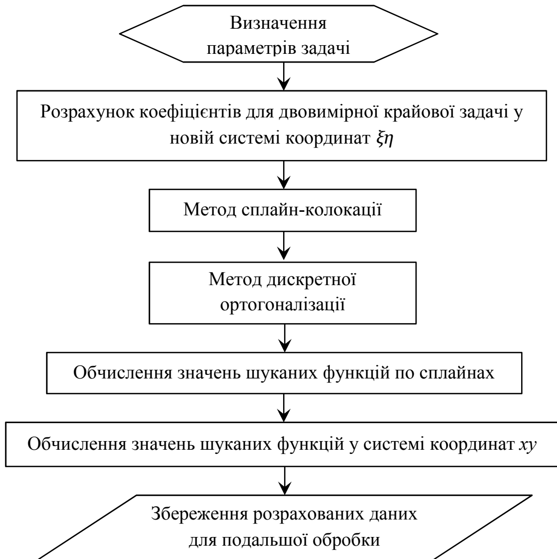
Рис. 3.3 — Блок-схема алгоритму розв'язання задач про напружено-деформований стан чотирикутних пластин з використанням уточненої моделі
