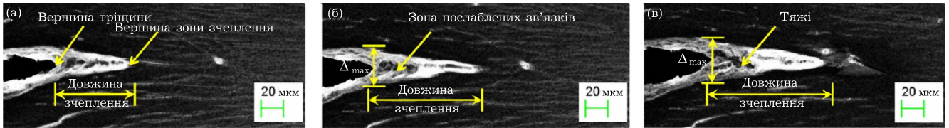
Рис. 1 – Зона передруйнування біля фронту тріщини
