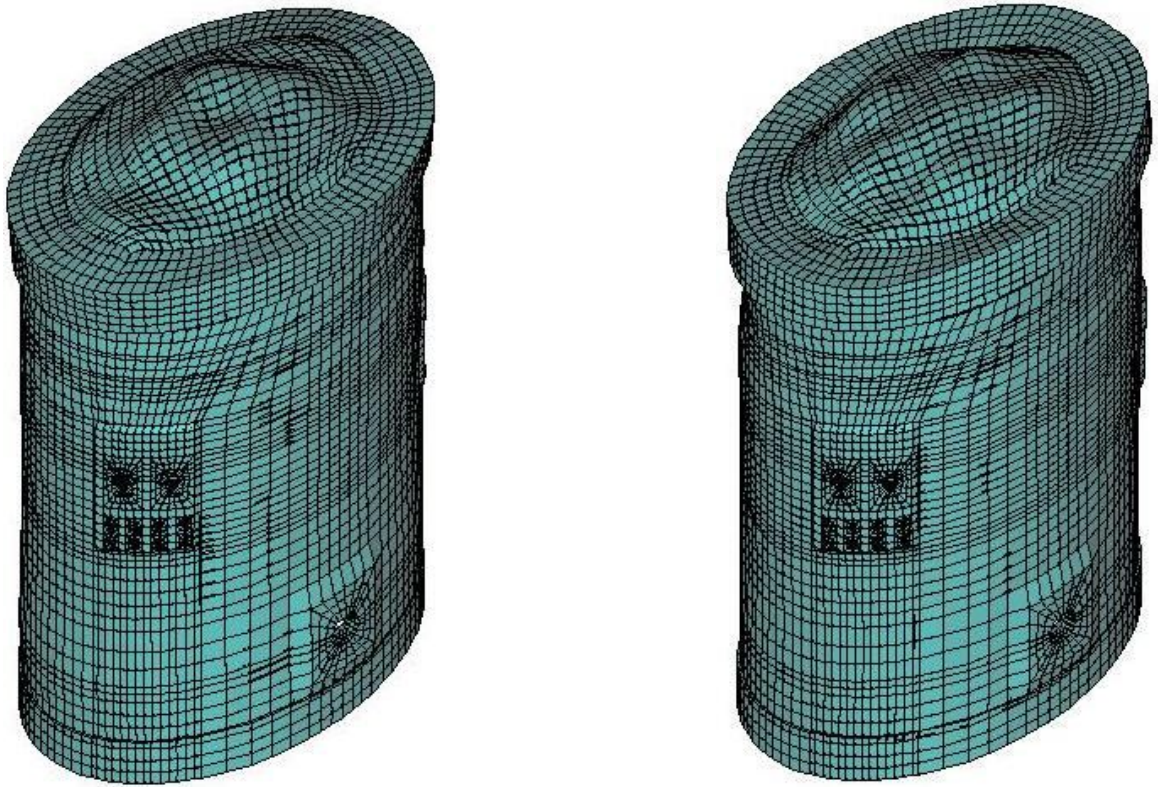
Рис. 4.9 Форми №№ 47, 70 власних коливань захисної оболонки
