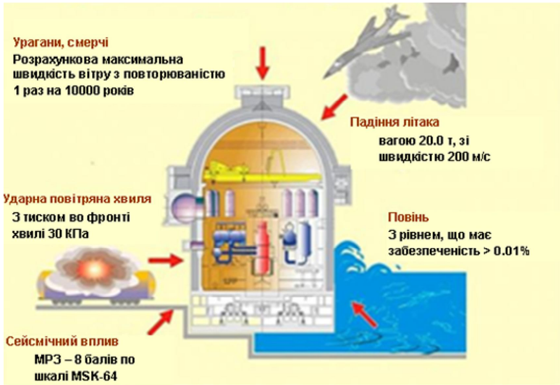
Рис. 4 Зовнішні природні і техногенні екстремальні (потенційно аварійні) впливи на ZO, які враховуються в проекті АЕС
